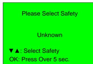
5. Wählen Sie durch drücken von  $\triangle$  oder  $\nabla$  den entsprechenden Ländercode aus. Wenn z.B. "VDE0126-1-1/A1" vom Netzbetreiber gefordert wird, drücken Sie  $\triangle$  oder  $\nabla$  solange bis "VDE0126-1-1/A1" im Display angezeigt wird.
