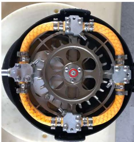
C. 確認噴嘴之堵塞狀況，可使用 10 號套筒卸下做清理
