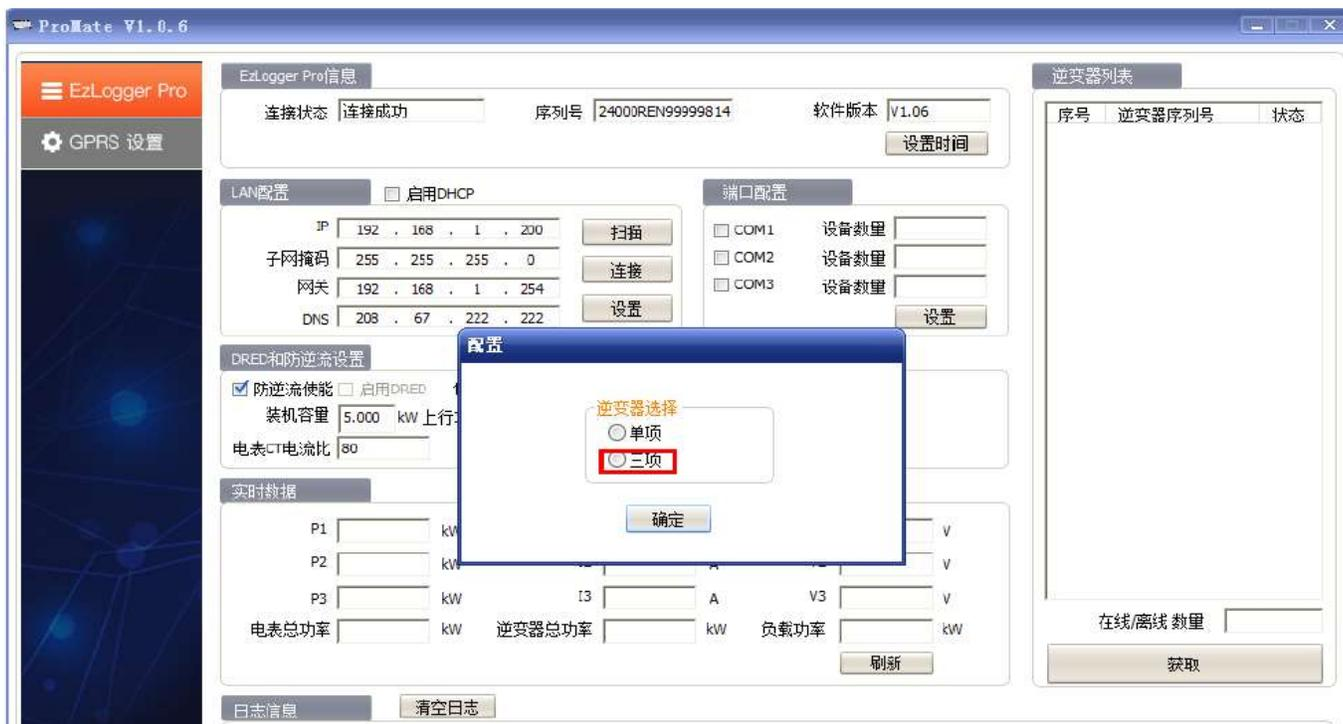
如果出現不能打開防逆流使能的情況，確認 Meter 與 EzLoggerPro 正確連接，COM4 燈恆亮。
