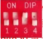
的“#3”撥到“ON” (後面)後，再將所有的 B4850 電池開機。
